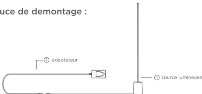
Le produit se compose de deux parties : (1) une source lumineuse et (2) un adaptateur. Si vous retirez le connecteur de sortie de l'adaptateur, vous pouvez facilement retirer la source lumineuse ou l'adaptateur.
