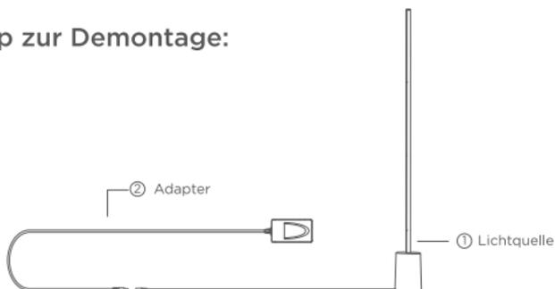
Das Produkt ist in zwei Teile unterteilt: (1) einer Lichtquelle und (2) einem Adapter. Durch Abnehmen des Ausgangsanschlusses des Adapters können Sie die Lichtquelle oder den Adapter leicht entfernen.
