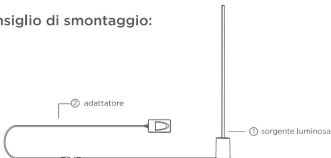
I prodotto diviso in due parti: (1) una sorgente luminosa e (2) un adattatore. Staccando il terminale di uscita dell'adattatore, puoi rimuovere facilmente la sorgente luminosa oladattatore.
