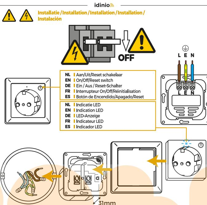
**NL** Schakel de stroom van de betreffende groep uit in de meterkast en test bij het bestaande stopcontact of de stroom daadwerkelijk uitgeschakeld is.
