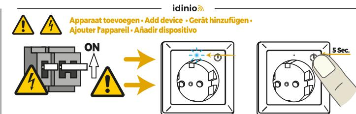
**NL** Nadat de stroom in de meterkast weer is ingeschakeld zal de LED indicator snel gaan knipperen. Indien dit niet het geval is dan moet u de slimme stekker resetten door 5 seconden op de power knop te drukken.
