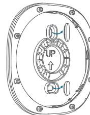
2. Instale o suporte da Sirene na parede com os parafusos fornecidos.
