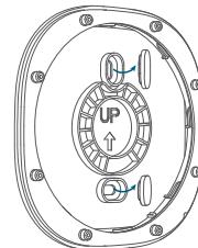
2. Montieren Sie die Halterung der Sirene mit den mitgelieferten Schrauben an der Wand.
