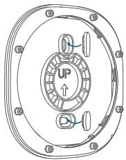
4. Positionnez la sirène sur son support et tournez dans le sens des aiguilles d'une montre pour aligner les marques sur le bord.
