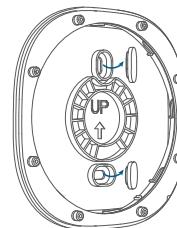
2. Installez le support de la sirène sur le mur avec les vis fournies.
