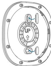
4. Coloque la sirena en el soporte y gírela en el sentido de las agujas del reloj para alinear las marcas con el borde.
