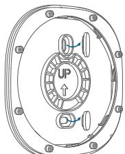
2. Installare la staffa dell'allarme Siren sulla parete con le viti in dotazione.
