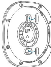
4. Posizionare l'allarme Siren sulla staffa e ruotare in senso orario per allineare i segni sul bordo.
