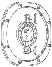
4. Positionieren Sie die Sirene auf ihrer Halterung und drehen Sie sie im Uhrzeigersinn, um die Markierungen an der Kante auszurichten.
