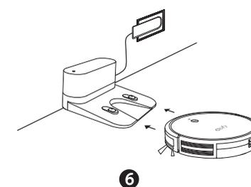
Полностью зарядите RoboVac перед использованием. Светодиодный индикатор на устройстве RoboVac пульсирует синим или пурпурным во время зарядки и постоянно горит синим, когда устройство заряжено полностью.
