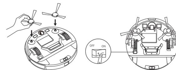
Quite el adhesivo que hay junto al interruptor principal y los bloques de espuma junto al paragolpes antes de usar el dispositivo.
