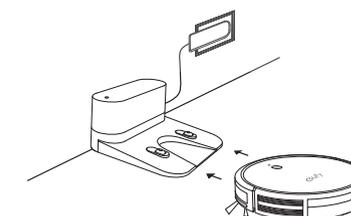
Cargue el RoboVac por completo antes de usarlo. El indicador LED del RoboVac parpadea en naranja mientras se carga y cambia a azul fijo cuando está totalmente cargado.
