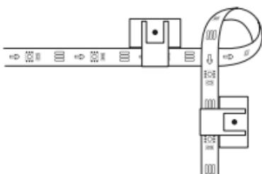
d. Ziehen Sie die Schutzfolie von der Steuerbox ab und kleben Sie sie auf.
