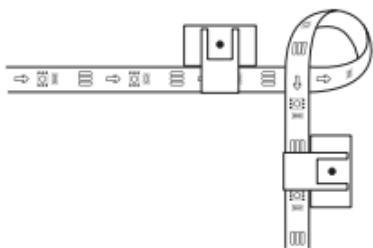
d. コントローラにある3m両面テープを剥がして、取り付けたところに粘着してください。
