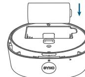
3. Vuelva a colocar la tapa del compartimento de la pila y gírela en el sentido de las agujas del reloj para cerrarla bien. Alinee bien las marcas.
