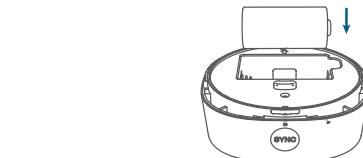
3. Bringen Sie die Batteriefachabdeckung wieder an und drehen Sie sie im Uhrzeigersinn, um sie zu verriegeln. Richten Sie die Markierungen sorgfältig aus.
