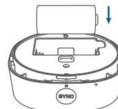
3. Replacez le couvercle du compartiment de la pile et tournez dans le sens des aiguilles d'une montre pour le verrouiller. Alignez soigneusement les marques.
