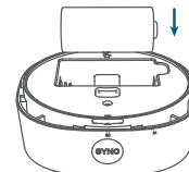
3. Riposizionare il coperchio del vano batteria e ruotarlo in senso orario per bloccarlo. Allineare i segni con attenzione.
