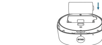
3. Volte a colocar a tampa do compartimento da bateria e rode no sentido dos ponteiros do relógio para a bloquear. Alinhe cuidadosamente as marcas.
